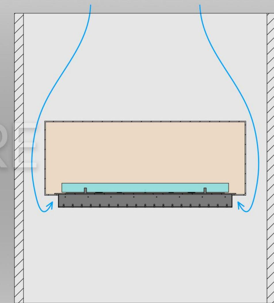
Установка камина в полую стену конструкция, которой открыта выше и ниже ниши для очага (без дополнительных перегородок). Тёплый воздух внутри стены будет вызывать негативные потоки, которые негативно скажутся на линии огня. Запрещённый вариант монтажа.
