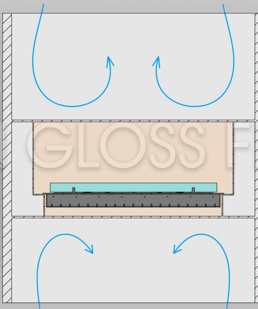
Установка камина в полую стену, в которой установлены дополнительные перегородки - выше и ниже ниши для очага. Убедитесь, что секция между перегородками герметична. Допустимый вариант монтажа.
