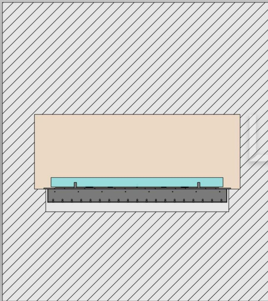
Установка камина в сплошную стену.
